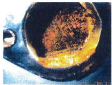
“BS21”使用后8ヶ月設備稼働後の WATER JACKET 部の状態 赤錆及びスケール除去効果が確実
