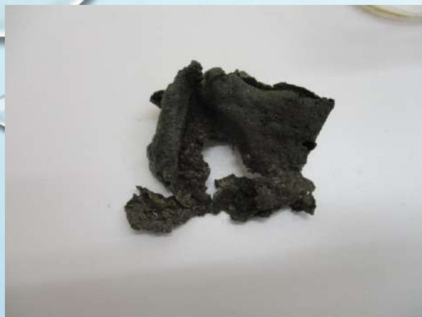
病院エアコンのドレン汚れ (乾燥状態)
